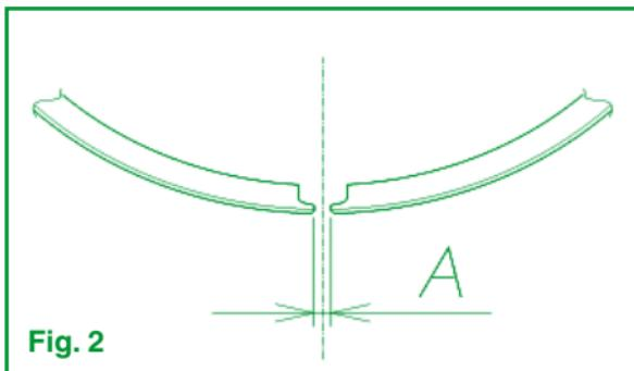
**Hinweis:** Vor der Montage des Kolbenrings am Kolben, kontrollieren, dass der Kolbenringstoß korrekt ist. Wie folgt verfahren:
