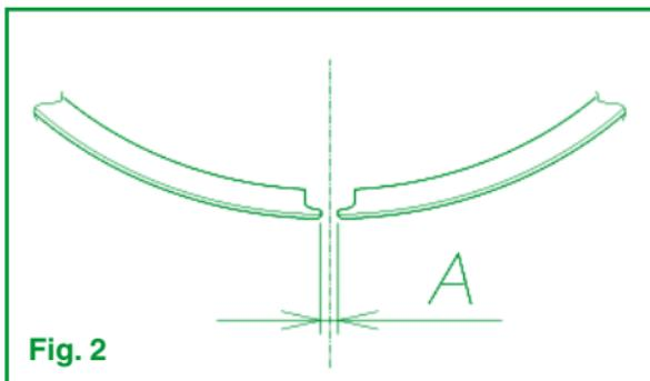
**Nota:** Prima di montare il segmento sul pistone controllare che la luce del segmento sia corretta. Procedere come segue:
