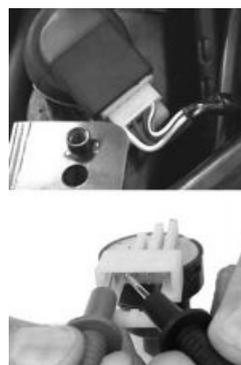
**14** - Verificare il connettore del teleruttore di arresto motore e l'efficienza del teleruttore stesso.
