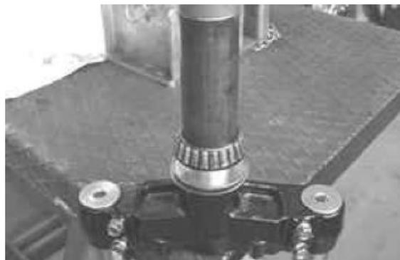
**Attrezzatura specifica****006029Y Punzone per montaggio sede ralla su tubo sterzo****Posteriore**
