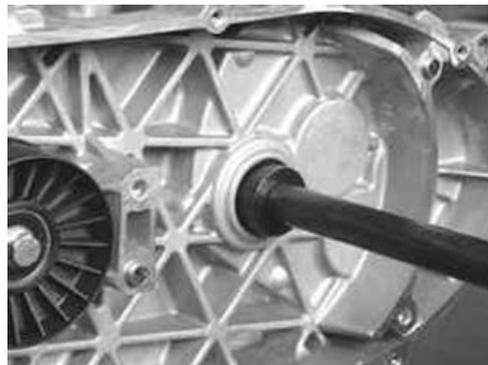
**Attrezzatura specifica****020376Y Manico per adattatori****020358Y Adattatore 37 x40 mm****020364Y Guida da 25 mm**
