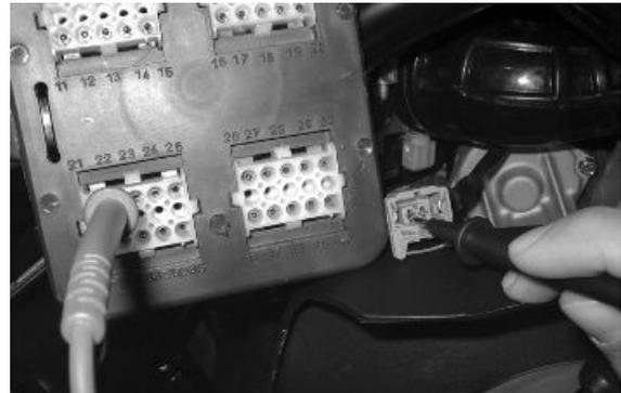
**12** - Riparare o sostituire il cablaggio.
