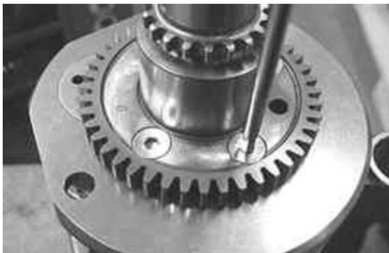
Soffiare con aria compressa e sgrassare i fori di fissaggio su entrambe le superfici in modo che la nuova LOCTITE faccia presa.
