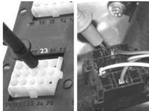
**23** - Ripristinare l'isolamento del cablaggio e sostituire il fusibile.
