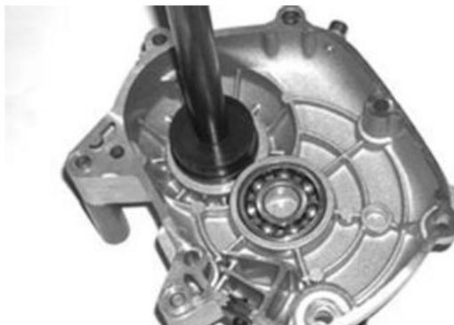
**Attrezzatura specifica****020376Y Manico per adattatori****020360Y Adattatore 52 x 55 mm****020476Y Kit colonnette****Montaggio ingranaggi mozzo**
