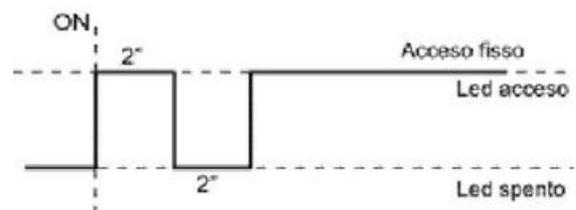
Quando il commutatore a chiave viene posizionato in «ON», si verifica l'accensione del LED secondo la modalità indicata in figura.
