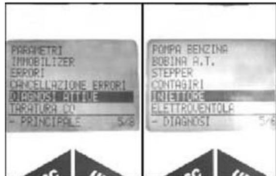
2 - Attivare la funzione con alimentazione sotto quadro inserita e motore fermo. La centralina comanda la pompa della benzina in modo continuo e contemporaneamente attiva l'apertura dell'iniettore. Le aperture dell'iniettore sono ripetute per alcuni secondi.
