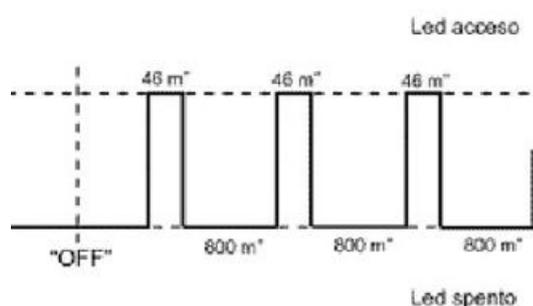
In caso di inutilizzo del veicolo, al fine di non scaricare eccessivamente la batteria, la funzione di lampeggio deterrente si interrompe automaticamente dopo 48h. Commutando dalle posizioni «OFF» «ON» «OFF» inizia un nuovo ciclo di 48h.
