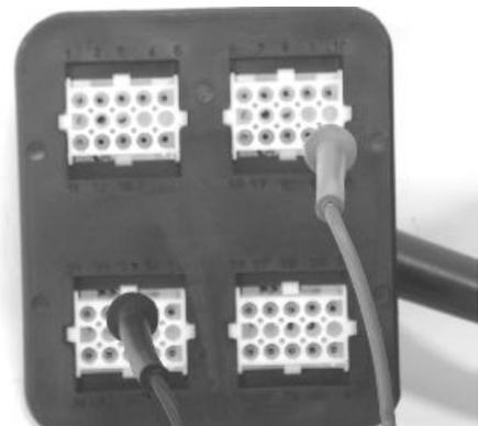
**7** - Il circuito di comando del primario della bobina è efficiente.
