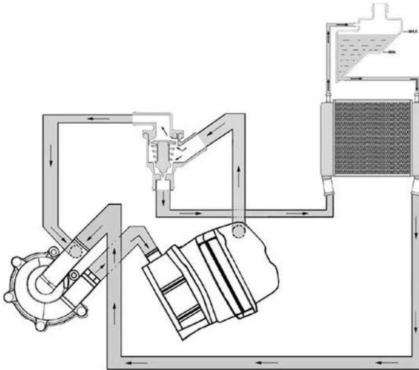
L'impianto di raffreddamento è del tipo a circolazione forzata con spurgo continuo e pressurizzazione in aria.
