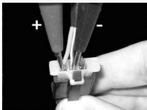
Rilevando tensioni diverse oppure la mancanza di alternanze, procedere con la sostituzione della ruota fonica.
