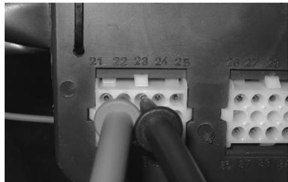
**14** - Ripristinare o sostituire il cablaggio. Verificare le linee di temp.liquido e posizione valvola.
