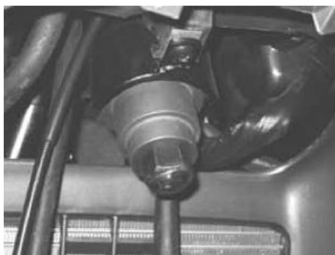
**Rimontaggio cuscinetto conico sul tubo sterzo**
