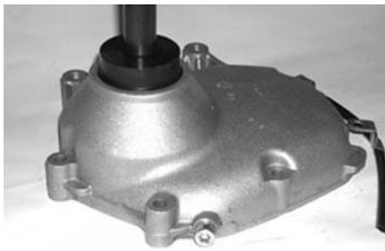
**Attrezzatura specifica****020376Y Manico per adattatori****020360Y Adattatore 52 x 55 mm****020483Y Guida da 30 mm**
