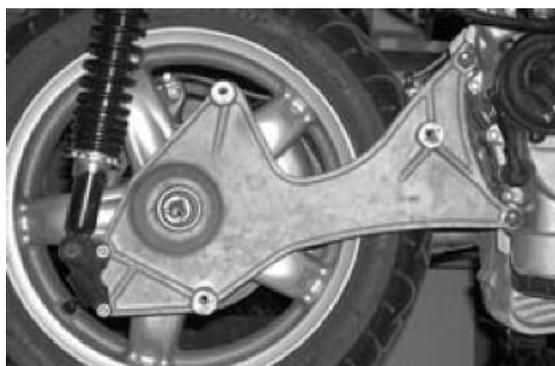
**Smontaggio perno inferiore dell'ammortizzatore sinistro**
