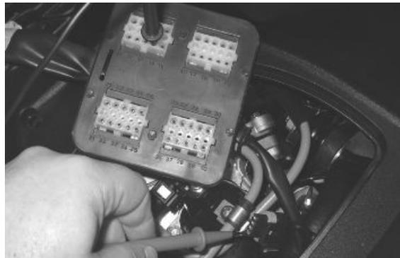
12 - Verificare l'isolamento da massa delle 4 linee dello stepper.
