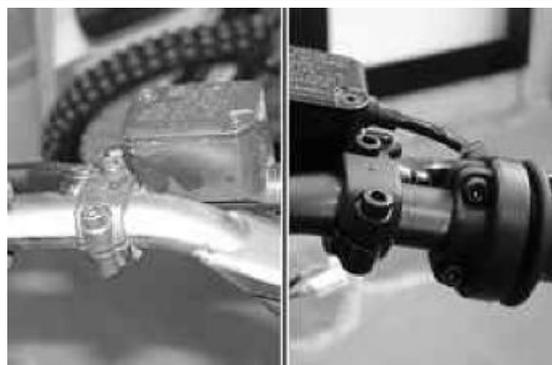
**SE LO SMONTAGGIO DEL MANUBRIO VIENE EFFETTUATO PER POTER PROCEDERE ALLO SMONTAGGIO DELLA FORCELLA, È SUFFICIENTE RIBALTARE IL MANUBRIO SUL CONTROSCUDO SENZA RIMUOVERE I PARTICOLARI MONTATI SOPRA, AVENDO CURA DI NON DANNEGGIARE LE TRASMISSIONI, LE TUBAZIONI O LA CARROZZERIA.**
