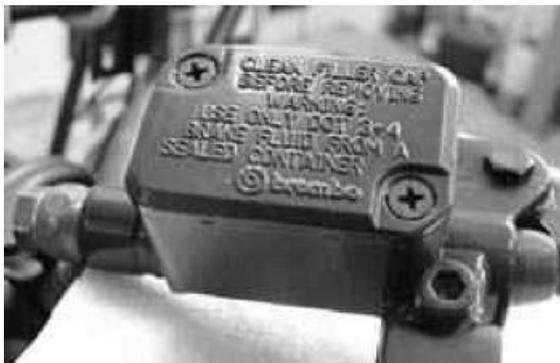
La leva freno sinistra permette di comandare contemporaneamente in modo asservito la pinza freno anteriore sinistra e la pinza freno posteriore. Per spurgare l'impianto integrale procedere per primo con lo spurgo della pinza freno posteriore.
