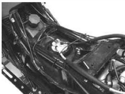
**NOTA BENE****PORRE MOLTA ATTENZIONE NELLO SFILARE LE TUBAZIONI DEL CARBURANTE IN QUANTO, ESERCITARE UNA FORZA ECCESSIVA, POTREBBE DETERMINARE UN DANNEGGIAMENTO DEGLI INSERTI IN PLASTICA SUL CORPO POMPA. E' NECESSARIO PERTANTO, ALLO SMONTAGGIO, PREMERE LEGGERMENTE LE TUBAZIONI E LA CORONA DI TRATTENIMENTO VERSO LA POMPA, SUCCESSIVAMENTE MANTENERE PREMUTA LA CORONA E SFILARE VERSO L'ALTO IL RACCORDO.**
