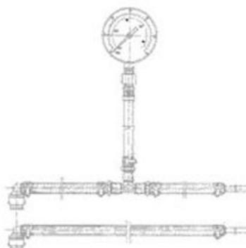
Scollegare il connettore elettrico dal supporto pompa con il motore in rotazione e attendere l'arresto. Il motore si ferma con circa 1,5 bar.
