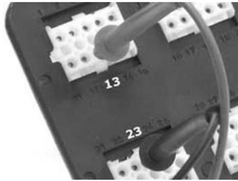
**16** - Il circuito elettrico dell'iniettore è continuativo. Ripetere i controlli. Nel caso in cui l'anomalia persista verificare il connettore della centralina. Se necessario sostituire la centralina.
