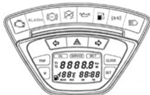
Le segnalazioni di riserva benzina; indicatori di direzione e lampeggio di emergenza vengono attivate mediante l'elettronica dello strumento. Ad esempio, la lampada spia di riserva benzina si accende solamente quando l'indicazione di riserva proveniente dal serbatoio persiste per almeno 13,5 secondi. Ciò evita l'accensione intermittente della spia di inizio riserva.
