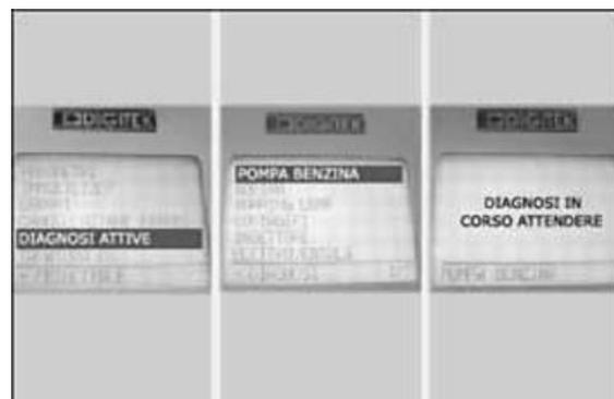
**28** - Selezionare il menù del tester di diagnosi sulla funzione «**DIAGNOSI ATTIVE**». Selezionare la funzione simulazione pompa benzina. Attivare la funzione con alimentazione sotto quadro inserita a motore fermo.
