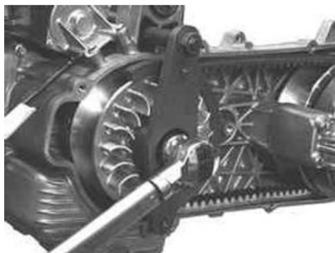
**Coppie di bloccaggio (N\*m)****Dado puleggia motrice 160 - 175****Montaggio contenitore rulli**
