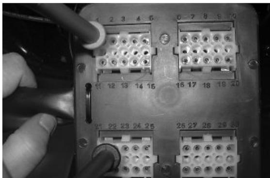
**13** - Misurare la tensione fra i terminali 11 e 22. Aprire progressivamente la valvola a farfalla e verificare che il valore di tensione incrementi in modo progressivo.
