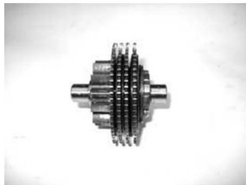
Il complessivo limitatore non è revisionabile. Qualora siano evidenti anomalie sui dischi dentati, è opportuno procedere con la sostituzione del complessivo.
