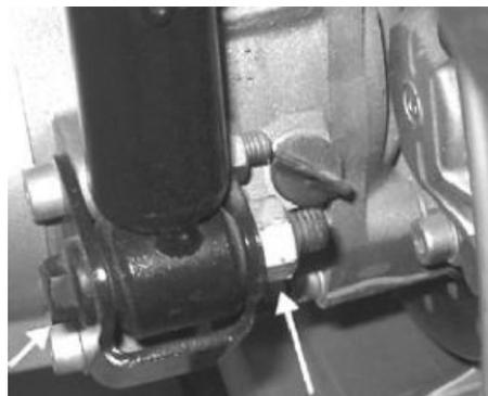
**Smontaggio perno motore-braccio oscillante**
