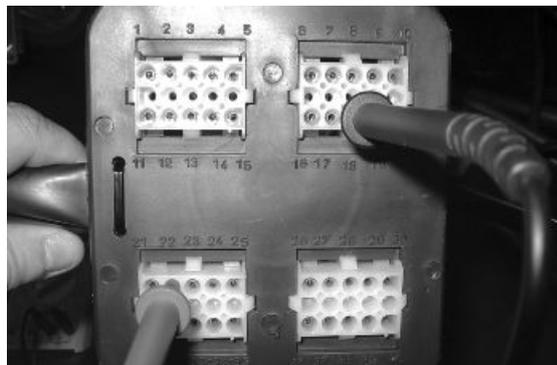
**11** - Rilevando valori di resistenza leggermente superiori, controllare i connettori.
