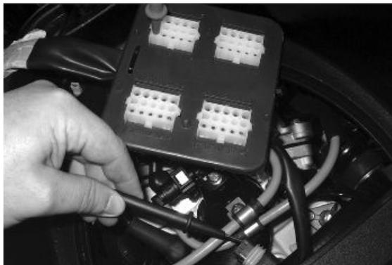
**7** - Ripristinare o sostituire il cablaggio dell'iniezione.
