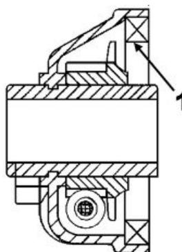
Di seguito indichiamo, con una freccia, la zona da ingrassare (1 - Presa di movimento, 2 - Ruota forata)
