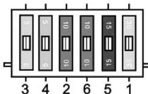
**8** - Eliminare l'eventuale cortocircuito del cablaggio e sostituire il fusibile.
