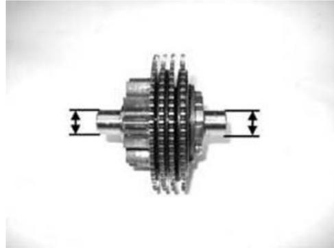
Verificare anche il diametro delle portate sul coperchio volano e sul carter motore.
