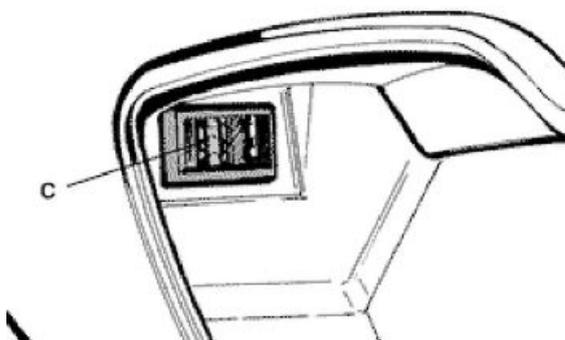
4. un fusibile da 30A (fusibile principale), collocato accanto alla batteria sul lato destro del veicolo e sul teleruttore di avviamento; al di sotto del quale è previsto anche un fusibile di ricambio.
