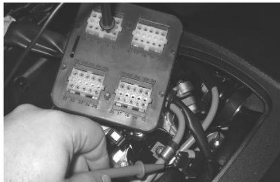
**15** - Verificare più accuratamente il cablaggio ed i connettori.
