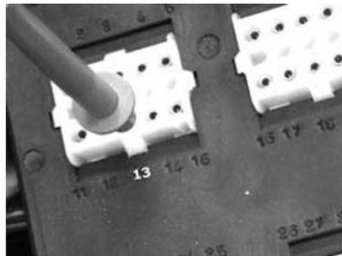
**18** - Manca la continuità. Scollegare il connettore e ripetere il controllo resistivo direttamente ai terminali dell'iniettore.
