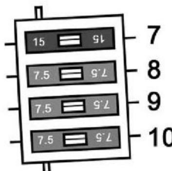
**3** - Verificare la presenza di eventuali corto circuiti sulla linea di alimentazione del gruppo strumenti, verificare che il gruppo strumenti non abbia corto circuiti.
