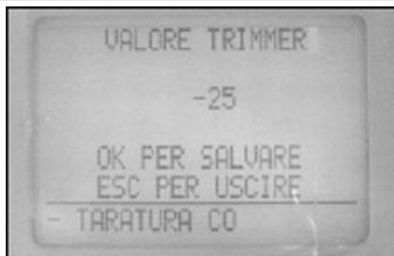
11 - Selezionare il menù del tester di diagnosi sulla funzione «TARATURA CO».
