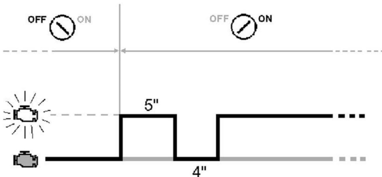
La segnalazione dell'anomalia è persistente ma la verifica del circuito viene effettuata solamente al momento della commutazione in «ON». Pertanto non vengono riconosciute le anomalie che si manifestano oppure scompaiono dopo la commutazione in «ON».
