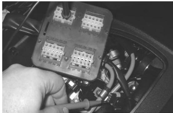
**13** - Riparare o sostituire il cablaggio.
