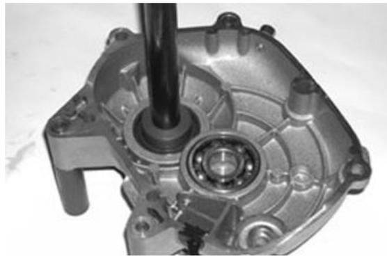
**Attrezzatura specifica****020476Y Kit colonnette****020376Y Manico per adattatori****020477Y Adattatore 37 mm****020483Y Guida da 30 mm**
